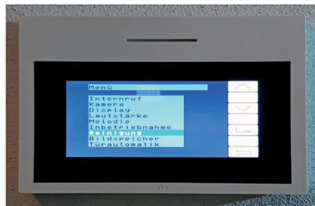
Die Klingel mit Magnetspulen ist mittlerweile durch ein Display ersetzt. Man kann darauf erkennen, wer vor der Haustür steht, mit ihm sprechen und die Tür öffnen.
