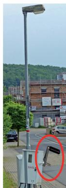
Manche Fußgänger fühlen sich nachts unsicher, wenn die Straßenlampen abgeschaltet sind. An einem Kasten ist eine **Leier**. Damit kann über einen Dynamo so viel Strom erzeugt werden, dass die Lampe zwei Minuten leuchtet.
