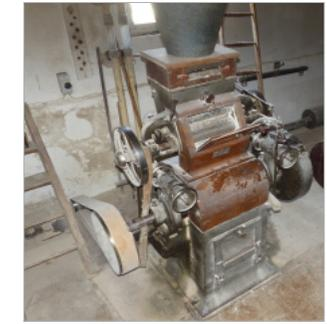
In der Spitzmühle sind Walzenstühle eingebaut. Sie sind seit 1820 in Mühlen verbreitet. Die Körner werden darin zwischen zwei Metallwalzen zerrieben.
