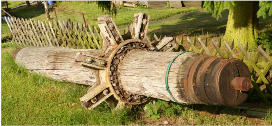
Hier liegt es, das alte Herz der Spitzmühle. Eine Reparatur wäre zu aufwändig und teuer geworden. Es war einfacher, innen im Mühlenhaus an die Achse des Mühlrades einen Generator anzuschließen und die Kraft von dort elektrisch auf die Mechanik der Mühle zu übertragen.
