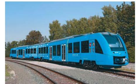
In der Wetterau fahren bereits Triebwagen mit Brennstoffzellentechnik. Sie wandeln überschüssigen Wasserstoff der Industrie in elektrische Energie um, die Elektromotoren antreibt. Diese können viel schneller beschleunigen als Dieselmotoren. Damit wirken sich zusätzliche Haltepunkte weniger auf die Gesamtfahrzeit aus.
