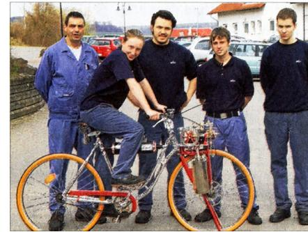
Welche Antriebe sind bei Fahrrädern üblich? Muskelkraft, Strom, Benzin, Diesel, Wasserstoff? Es fehlt noch Dampf. Die Gießener Allgemeine berichtete am 20. April 2006 über eine Lehrlingswerkstatt, die das Dampf Fahrrad baute.
