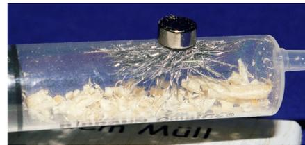
Lassen sich die Atome, wie hier bei den Eisenfeilspänen ausrichten, werden sie selbst magnetisch. Sie und der Magnet ziehen sich gegenseitig an.
