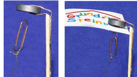
Warum ist aber etwas magnetisch? Atome haben ein kleines Magnetfeld, weil Elektronen um sie kreisen. Sind diese Atome unterschiedlich ausgerichtet, heben sich diese vielen kleinen Magnetfelder gegenseitig auf.
