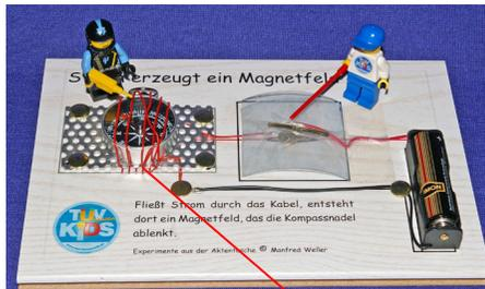
Die Kinder bauen dieses TÜV Kids Exponat selbst. Sie wickeln eine kleine Spule um den Kompass. Schließen sie mit dem Tastschalter den Stromkreis, erzeugt der Strom in der Spule ein Magnetfeld und lenkt die Kompassnadel ab.
