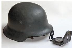
Im Kompass ist eine Magnetnadel drehbar gelagert. Sie richtet sich nach dem Magnetfeld der Erde aus.
