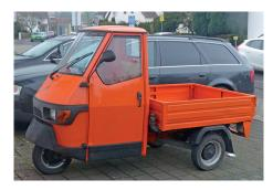
Gefahren und gelenkt wird dieser "Moped-LKW" mit einer Lenkstange wie ein Moped.
